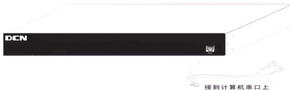
图 2-3 将 Console 线缆连接到交换机上示意图
